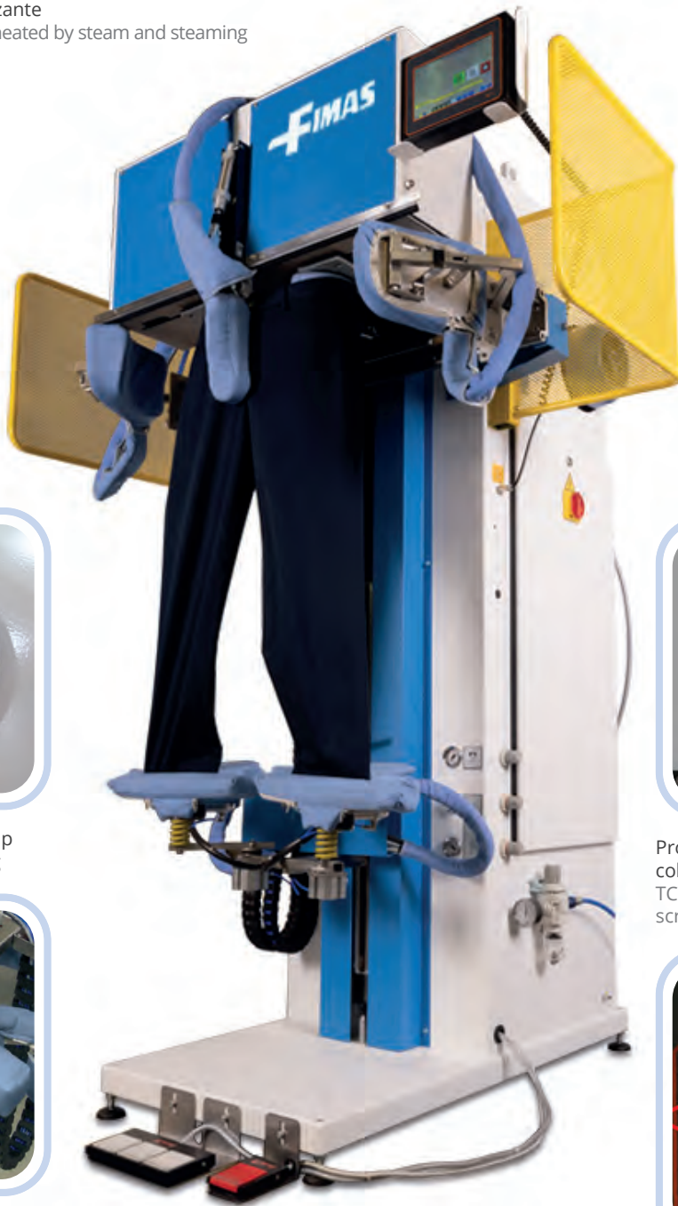
Stabilizzazione tessuto con aria fredda. Fabric stabilization with cold air. (vers.25-28)
